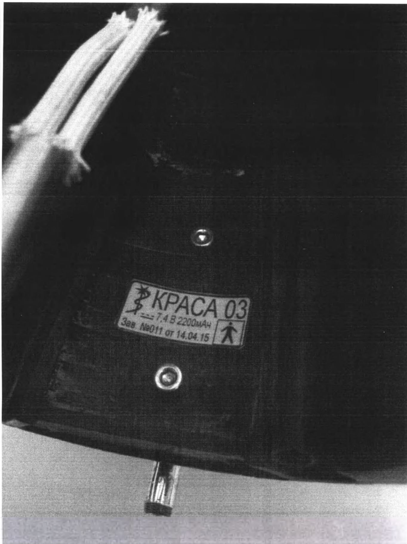
Аппарат криогенный струйно-аппликационный «КРАСА» исполнение КРАСА03. Внутренняя задняя поверхности корпуса аппарата КРАСА03 после отсоединения колбы криостата от корпуса. Видна маркировка прибора.
