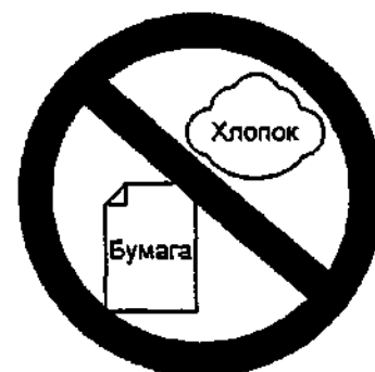
Рис. 2-2: Материалы, выполненные из целлюлозы, содержащие хлопок и бумагу изделия, загружать в стерилизатор не следует
