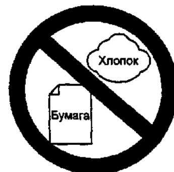
Рис. 3-4: Материалы, выполненные из целлюлозы, содержащие хлопок и бумагу изделия, загружать в стерилизатор не следует
