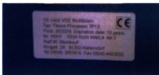
Рис. 7 Шильда прибора на примере Гистопроцессора TP12
