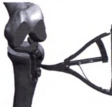
Рисунок 42. Распределитель тонких пластинок, прикрепленный к натяжному приспособлению для томографии коленей
