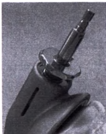
Ручка расширителя, закрепленная в рабочем инструменте
