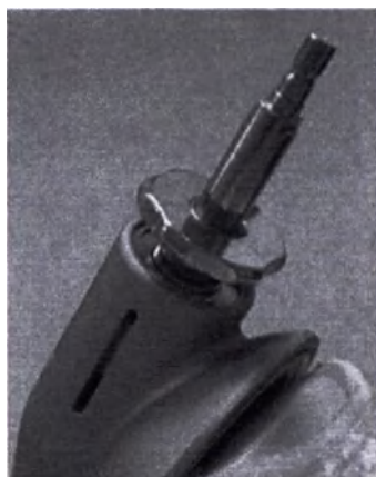
Ручка расширителя, закрепленная в рабочем инструменте
