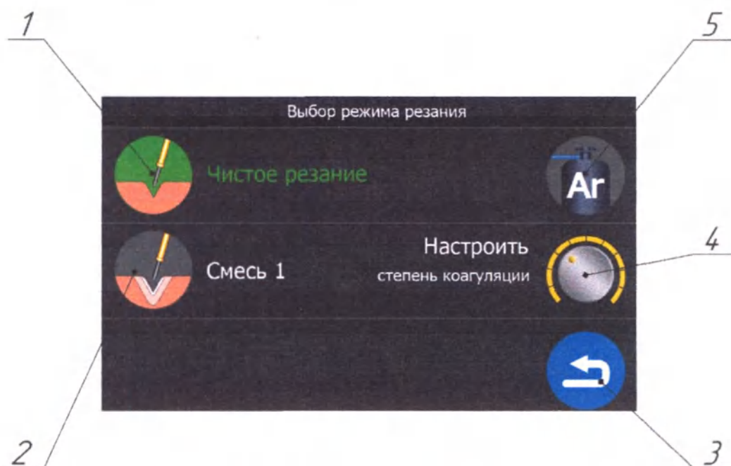
Рисунок 4 - внешний вид экрана меню выбора режима резания аппарата, где 1 – иконка выбора режима «Чистое резание», 2 – иконка выбора режима «Смесь», 3 – иконка возврата в предыдущее меню, 4 – иконка меню настройки степени коагуляции в режиме «Смесь», 5 – иконка активации функции подачи аргона(только «ПРОМЕТЕЙ -А»).
