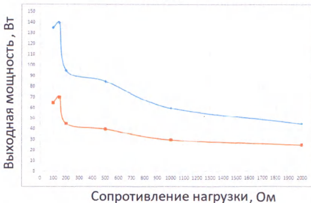
Рисунок 17 - зависимость выходной мощности от сопротивления нагрузки в режиме «СМЕСЬ 6»
