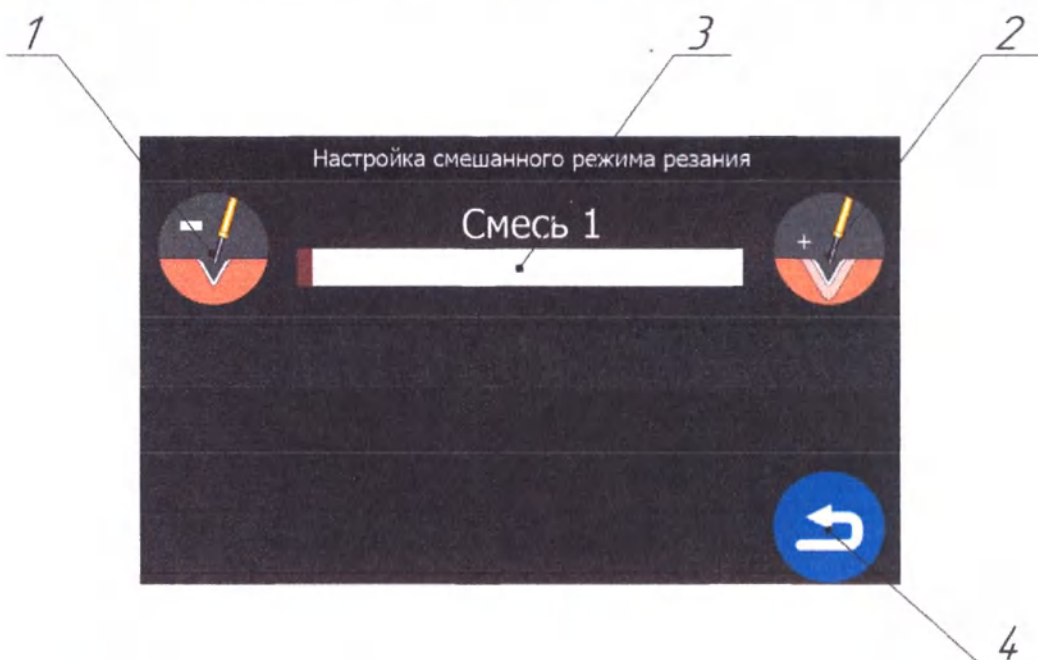
Рисунок 5 - внешний вид экрана меню настройки смешанного режима резания, где 1 – иконка уменьшения эффекта коагуляции в режиме «Смесь», 2 – иконка увеличения эффекта коагуляции в режиме «Смесь», 3 – слайдер изменения эффекта коагуляции с индикатором в режиме «Смесь», 4 – иконка для выхода в предыдущее меню.
