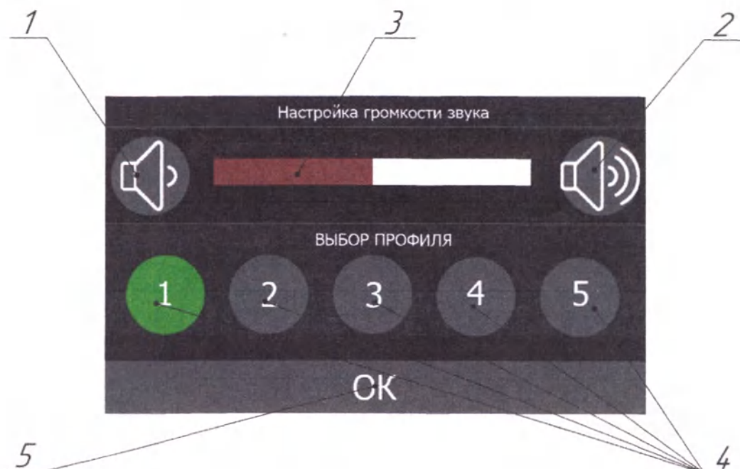
Рисунок 10 - внешний вид экрана меню настройки громкости звука и выбора профиля, где 1 – иконка для уменьшения громкости звуковых сигналов, 2 – иконка для увеличения громкости звуковых сигналов, 3 – слайдер для регулировки громкости звуковых сигналов, 4 – иконки для выбора профиля сохранённых настроек, 5 – иконка возврата в главное меню.
