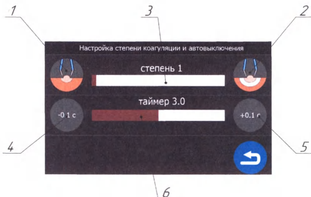
Рисунок 9 - внешний вид экрана меню настройки степени коагуляции и автовыключения в режимах коагуляции, где 1 – иконка для уменьшения степени коагуляции при включенной функции автовыключения в режиме «КОАГУЛЯЦИЯ БИ», 2 – иконка для увеличения степени коагуляции при включенной функции автовыключения в режиме «КОАГУЛЯЦИЯ БИ», 3 – слайдер с индикатором для регулировки степени коагуляции при включенной функции автовыключения в режиме «КОАГУЛЯЦИЯ БИ», 4 – иконка для уменьшения времени воздействия коагуляции при включенной функции «По таймеру», 5 – иконка для увеличения времени воздействия коагуляции при включенной функции «По таймеру», 6 – слайдер с индикатором для регулировки времени воздействия коагуляции при включенной функции «По таймеру».
