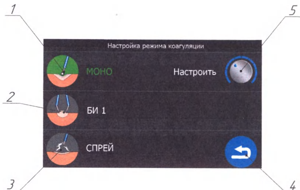
Рисунок 6 - внешний вид экрана меню настройки режима коагуляции, где 1 – иконка выбора монополярного режима «КОАГУЛЯЦИЯ МОНО», 2 – иконка выбора биполярного режима «КОАГУЛЯЦИЯ БИ», 3 – иконка выбора режима коагуляции «СПРЕЙ», 4 – иконка для выхода в предыдущее меню, 5 – иконка для захода в меню настройки коагуляции.
