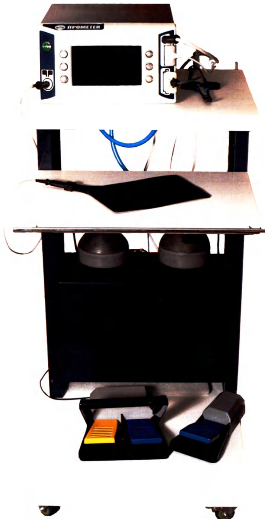
Фотография 1. Аппарат электрохирургический высокочастотный «ПРОМЕТЕЙ» с функцией подачи аргона на передвижной стойке «ПРОМЕТЕЙ – А» по ТУ 32.50.50-016-39136787-2020, вид спереди.
