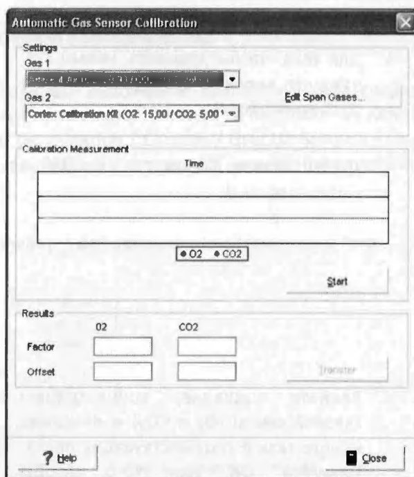
Начало калибровки с помощью Газы 1
