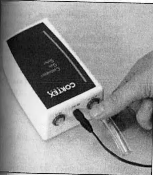
Подключение короткой трубки к ручному калибратору
