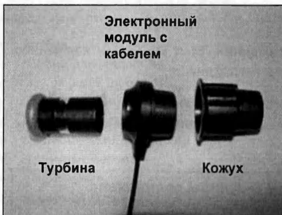
Разборка датчика потока
