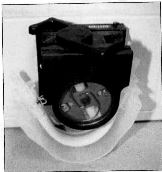
Удаление держателя и трубки из перистальтического насоса
