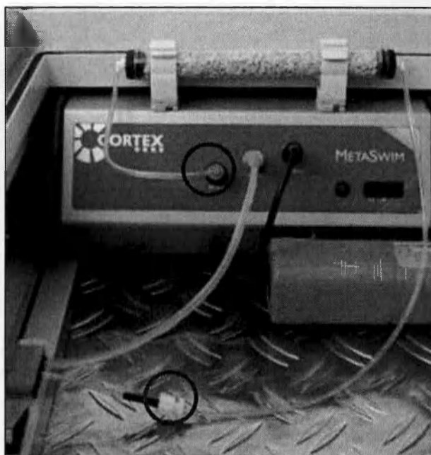
Подсоединение осушающих трубок
