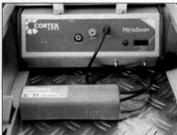
Подключение аккумулятора к перистальтическому насосу для удаления слюны
