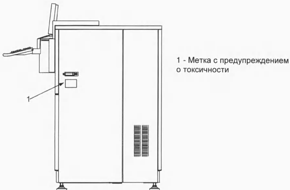
Рис. 4-10. Метки на правой стороне аппарата
