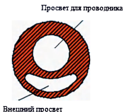
Рис. 2. Сечение дистальной части катетера в области порта проводника
