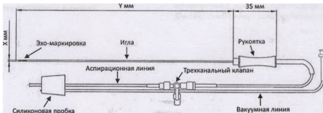
Рисунок 8: Игла Kitazato OPU Needle для забора ооцитов с аспирационной линией / силиконовой пробкой с вакуумной линией / трехканальным клапаном
