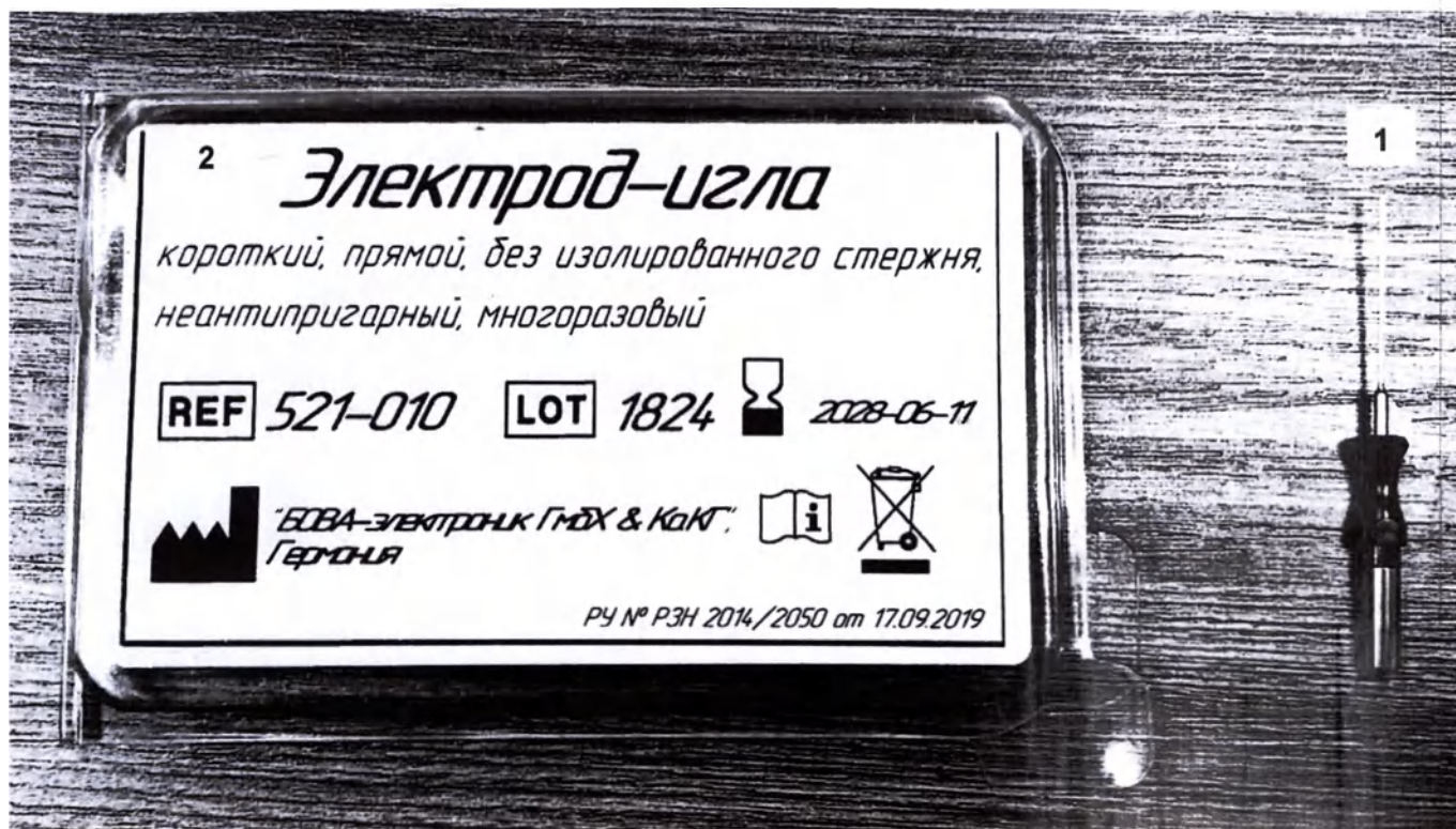
Фотографическое изображение электрода-иглы короткого; прямого; без изолированного стержня; неантипригарного, многоразового; без упаковки (1) и в упаковке (2).
