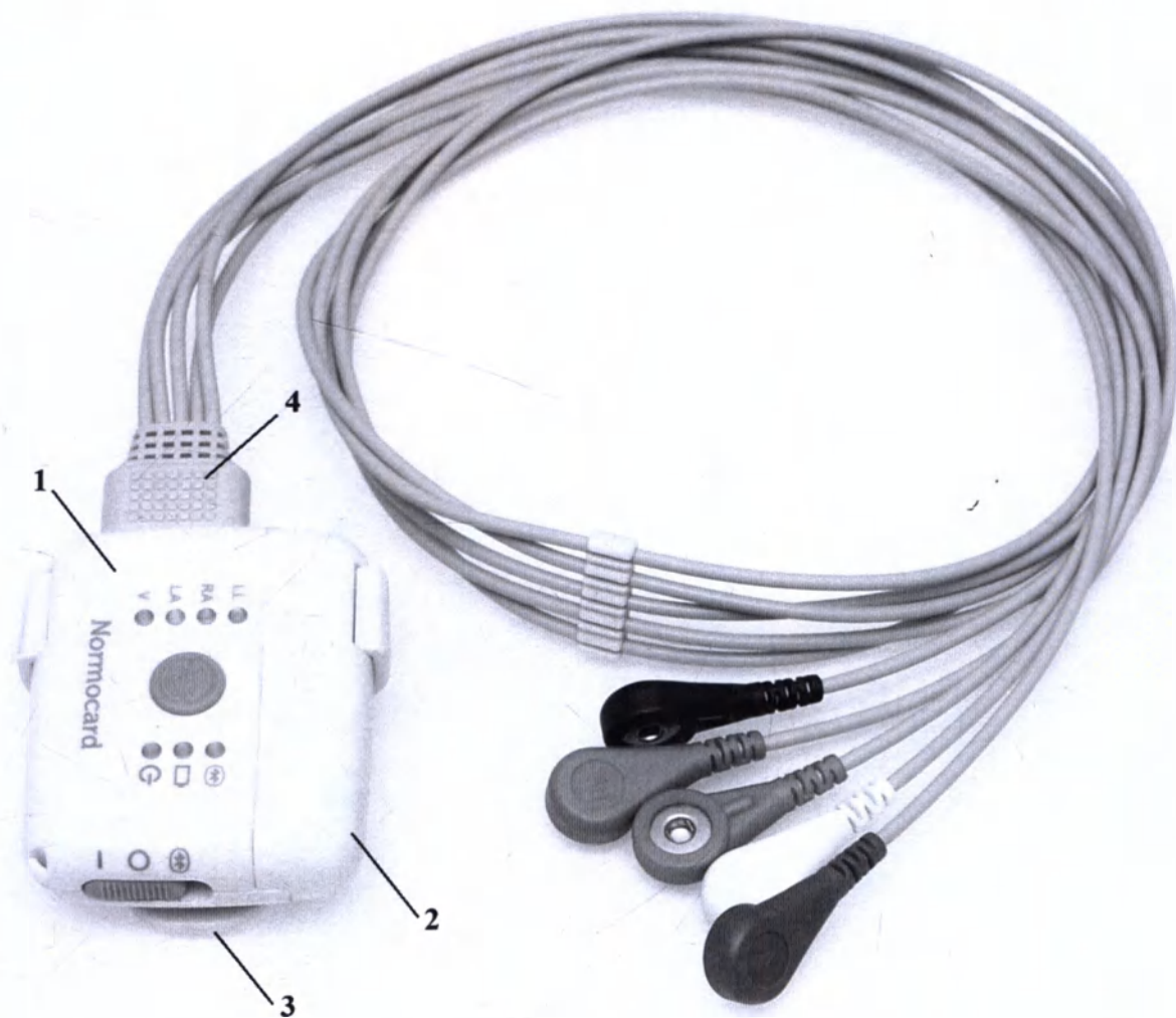
Рис. 2 Регистратор QRS24-002 (1) в собранном виде с закрытой крышкой батарейки (2), присоединенной клипсой (3) и подключенным Кабелем для подключения сенсоров экранированным 5Э 2.5/3.5 (4)
