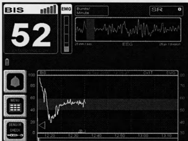
Рис. 10. Экран тренда BIS с индикатором заряда аккумулятора, целевым интервалом значений, коэффициентом подавления и счетчиком всплесков ЭЭГ активности
