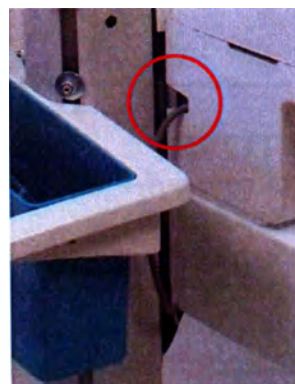
Figura 1.33: Particolare del punto di accesso per la connessione dati Ethernet.
