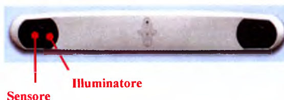
Figura 1.10: Il sensore di tracking.
