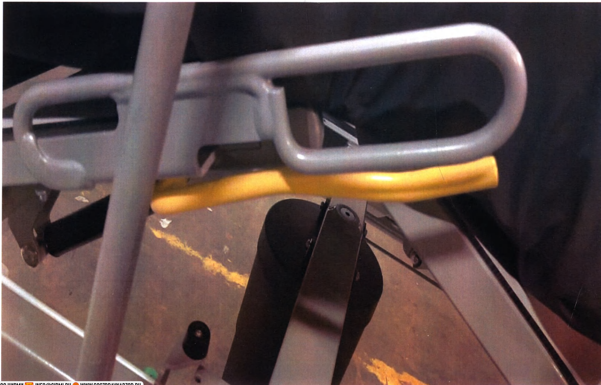
1.7. Механическая система регулировки бедренной секции с 2-мя рычагами (1 шт.).
