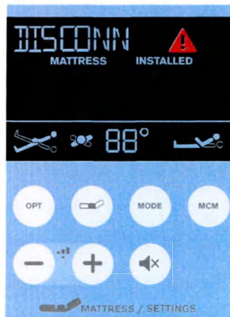
Рис. ВОЗДУХОПРОВОДЫ ОТКЛЮЧЕНЫ
