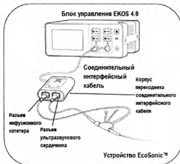
Рисунок 1. Эндоваскулярная система EkoSonic (без шнура электропитания)
