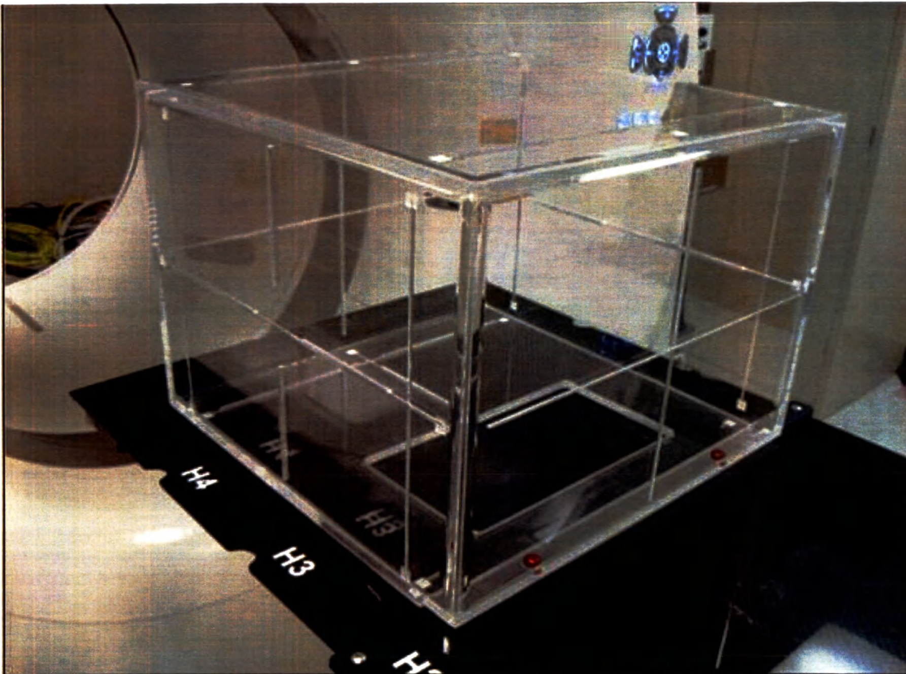
30.2. Набор инсталляционный для точного многокомпонентного выравнивания плоской деки стола: фантом; пластины для деки стола (2 шт.); монтажный материал; электрощит распределительный.
