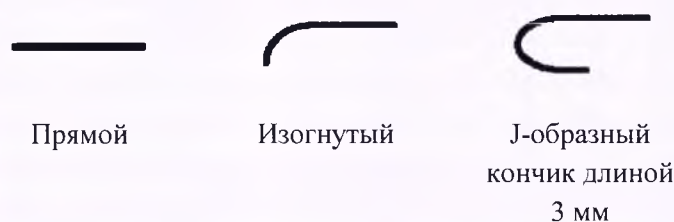
Рисунок 1. Формы дистальных наконечников проводника с покрытием ПТФЭ
