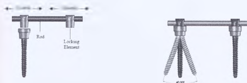
Рисунок 6: Конструкция из имплантатов и блокирующих элементов.
