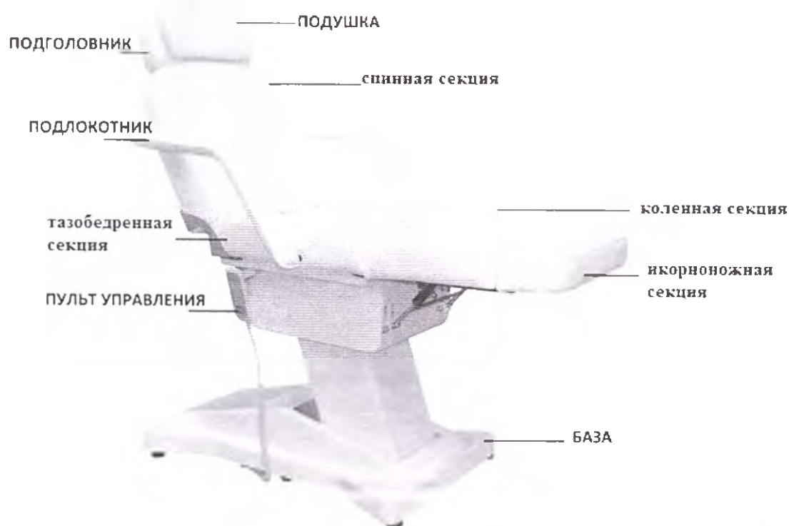
Рисунок 1 Конструкция изделия(на данном рисунке изображен общий вид изделий серии ММКК. с более подробным изображением, а также конструктивными особенностями изделия ММКК-1, ММКК-2, ММКК-3, ММКК-4, можно ознакомиться в паспортах к данным изделиям, которые
