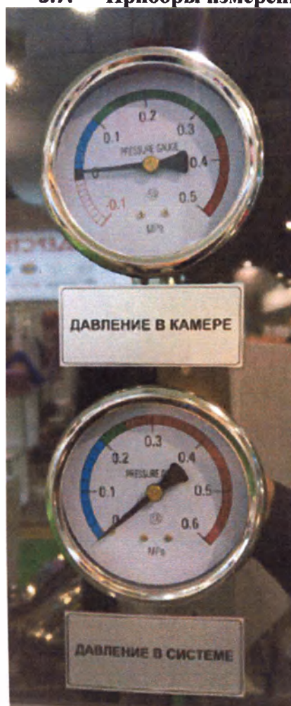
Рисунок 18 – Мановакуумметр и манометр на панели автоклава.
