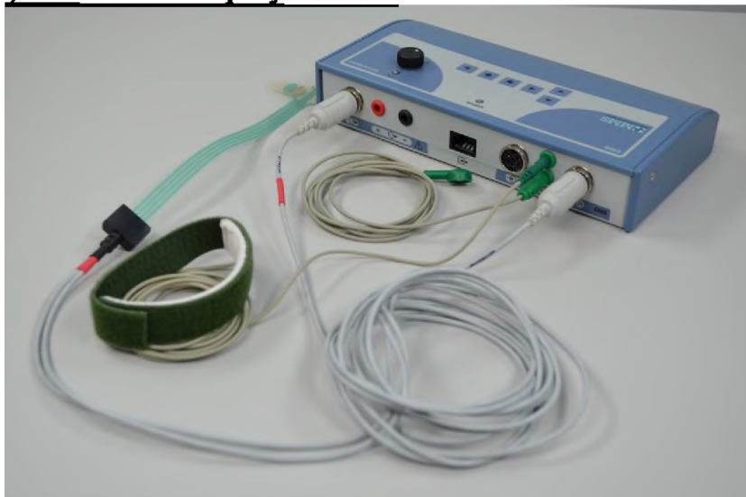
Рисунок 14.18 Подключение кабелей к высокоскоростному цифровому модулю ЭМГ для поверхностной и игольчатой ЭМГ
