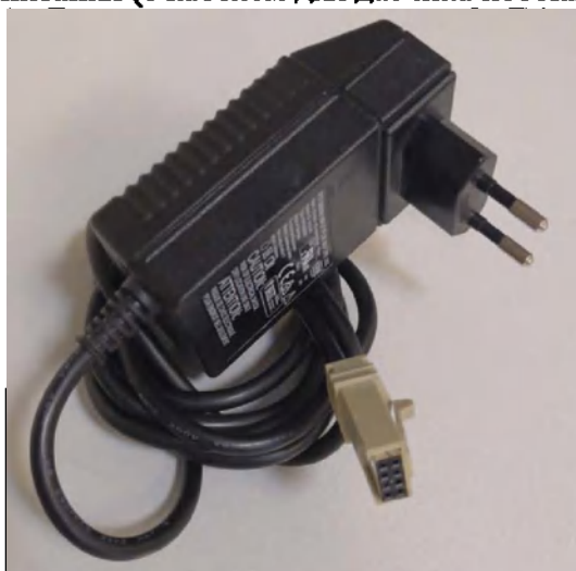
Рисунок 2.32 Общий вид блока питания (с кабелем для датчика потока)
