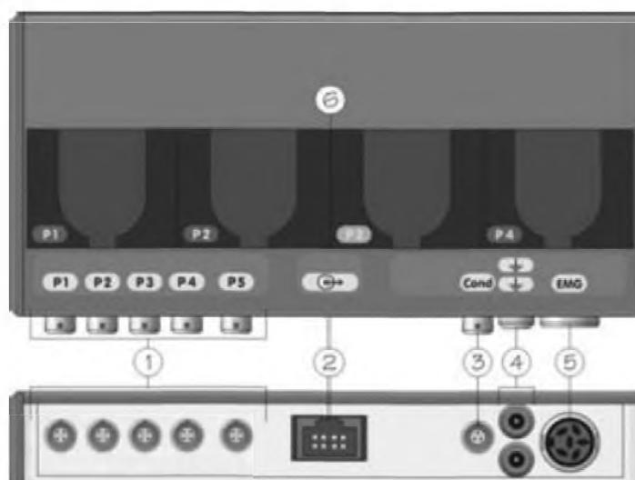
1 Разъем Lemo 4 для датчиков давления (2..5 разъемы) 2 Разъем для кабеля к основному модулю U2M 3 Разъем Lemo 3 для проводимости 4 Заземление 5 6-полюсный разъем DIN для ЭМГ 6 Держатель для многоразовых датчиков давления Рисунок 8.1 Общий вид SIM 4E модуля измерения давления и ЭМГ, включая держатель датчиков давления
