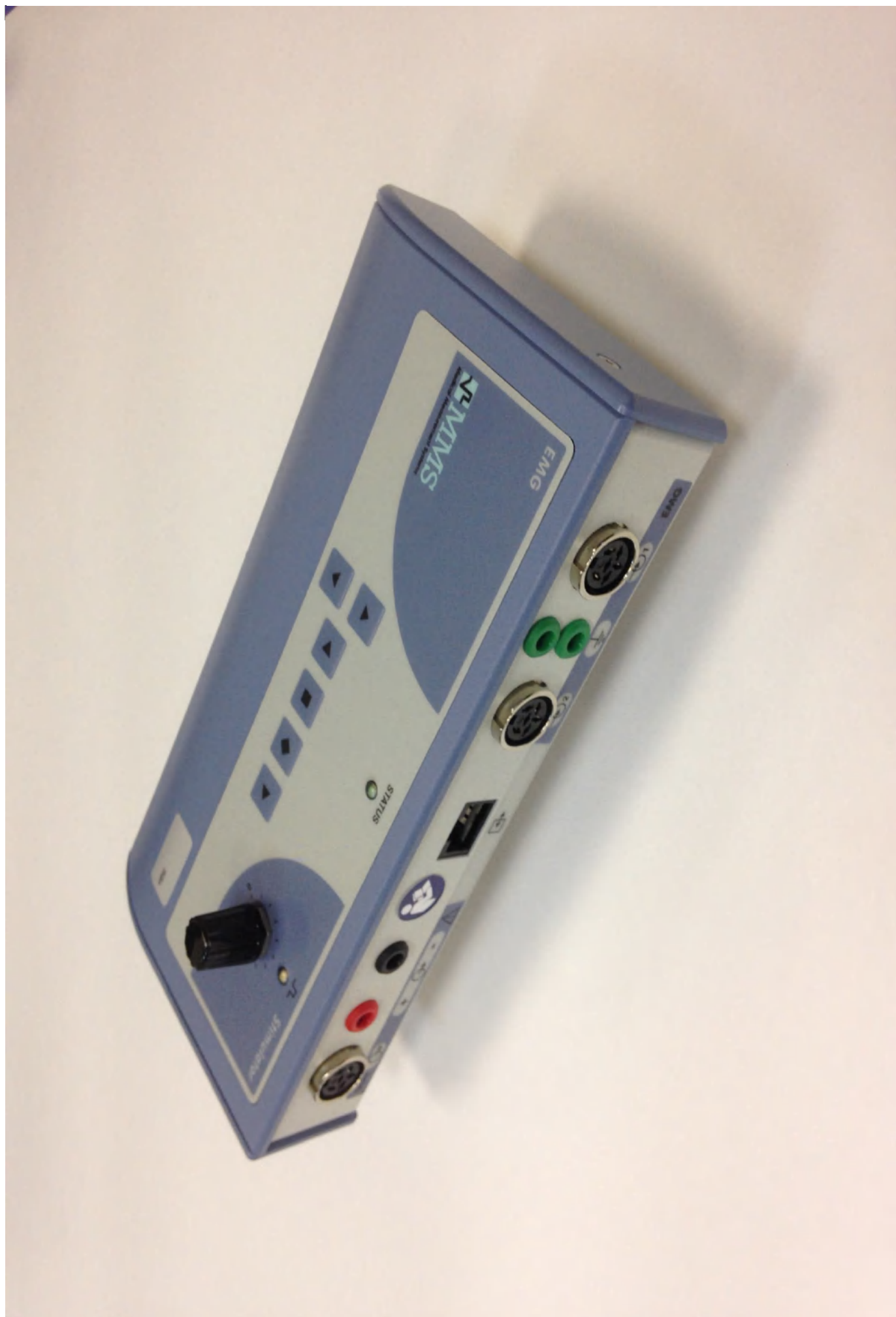
Рисунок 19 – Высокоскоростной цифровой модуль ЭМГ для поверхностной и игольчатой ЭМГ (п. П. 116 РУ № ФСЗ 2010/07671)
