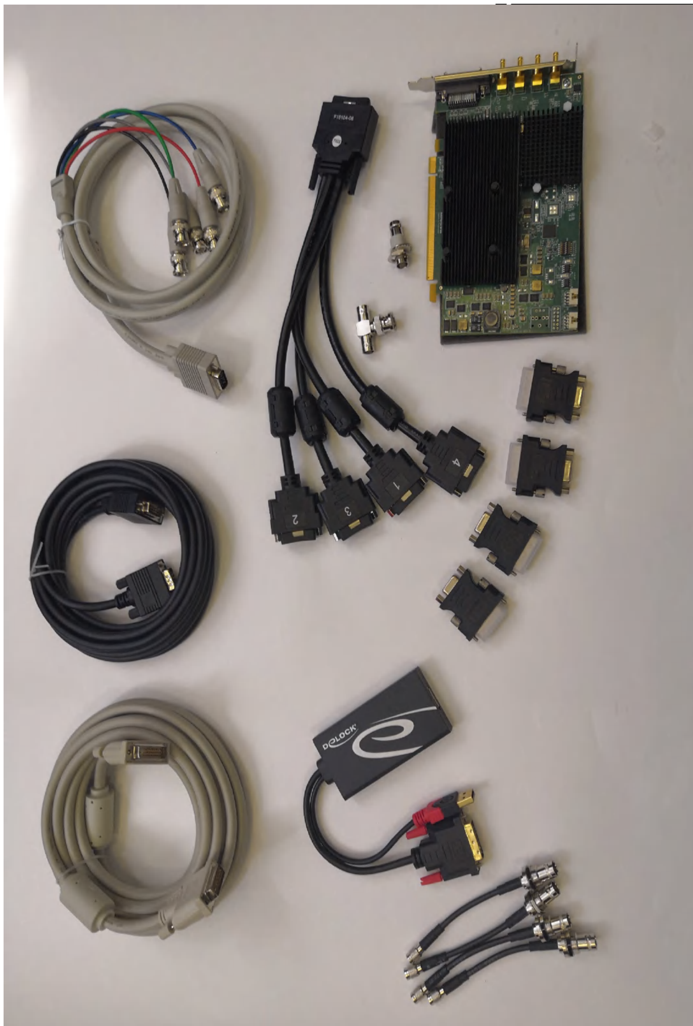
Рисунок 32 – Канал «Видео», включая ПО и видеоплату Orion
