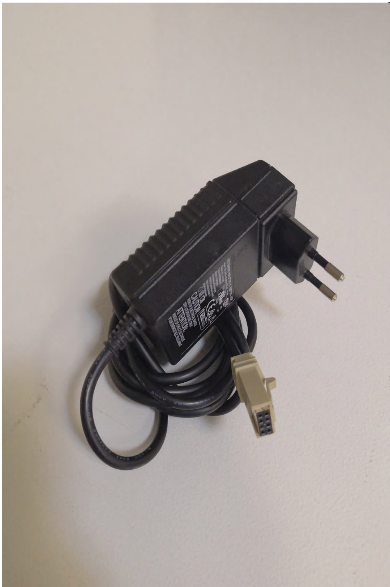
Рисунок 79 - Блок питания (с кабелем для датчика потока) (п. II. 37 РУ № ФСЗ 2010/07671)
