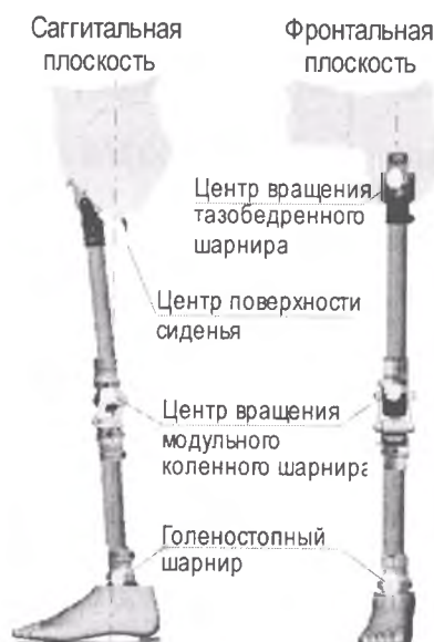
Рисунок 2 – Пример схемы построения протеза при вычленении в тазобедренном суставе
