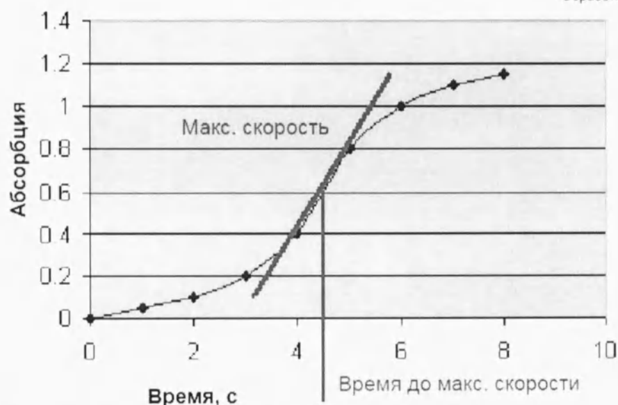
Рисунок 4-15. Определение времени до максимальной скорости
