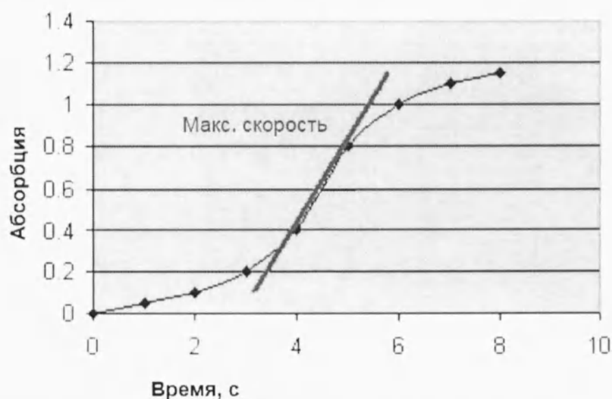
Рисунок 4-14. Определение максимальной скорости при помощи значения 2 в окне.
