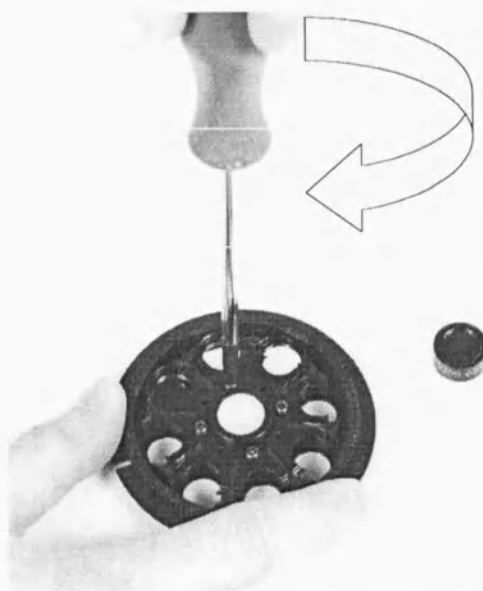
Рисунок 6-18. Извлечение винтов крепления пружины.
