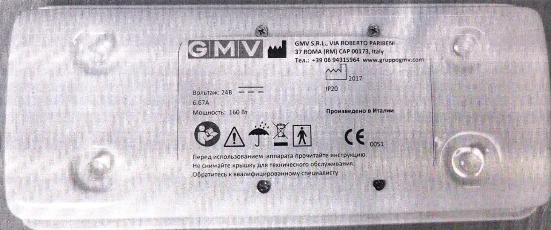
Фото 9. Маркировка мобильного блока зарядки
