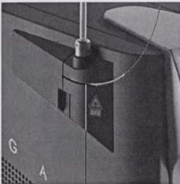
Позиция 3 Апертура Лазера
