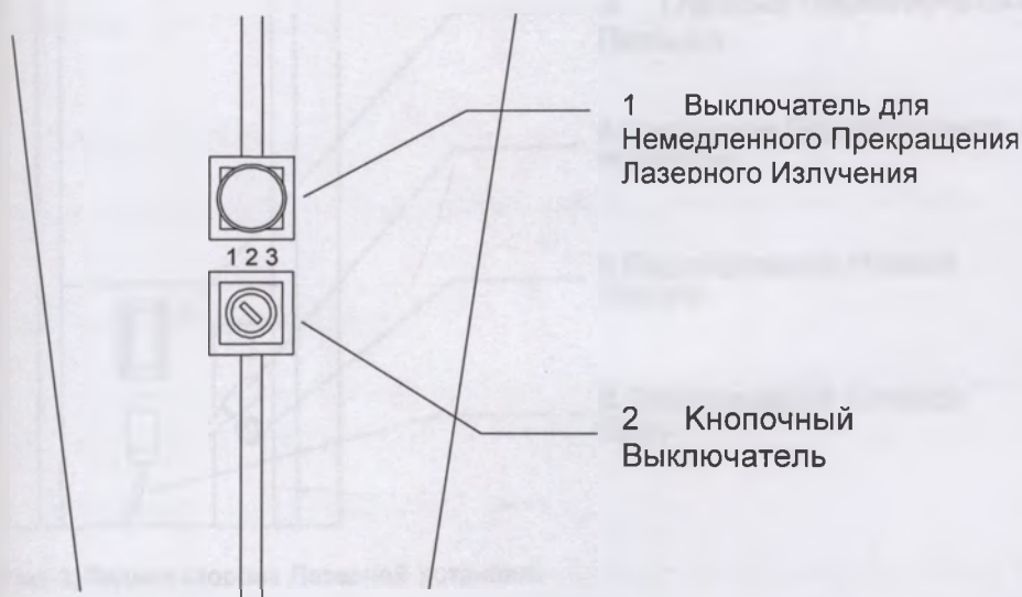
Рис. 2: Передняя сторона Лазерной Установки
