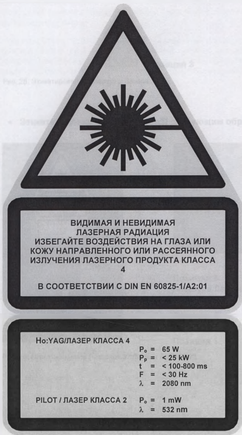
Рис. 24: Предупреждающие и Указательные Обозначения на Лазерной Установке
