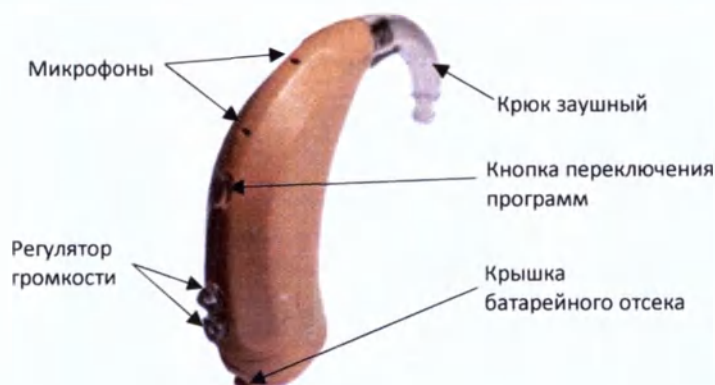
Рис. 4 – Схема аппарата слухового электронного заушного воздушной проводимости «Нота», моделей 6SP, 8SP, 12SP, 16SP
