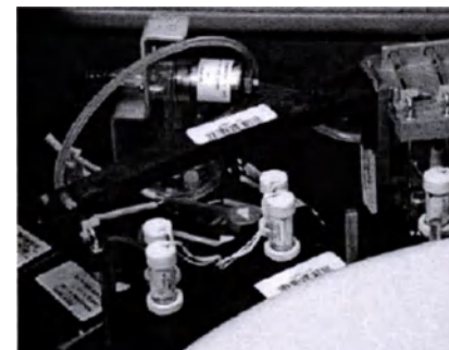
Рисунок 1.68: Устройство дозирования Пре-Триггер и Триггер растворов (PT/T)
