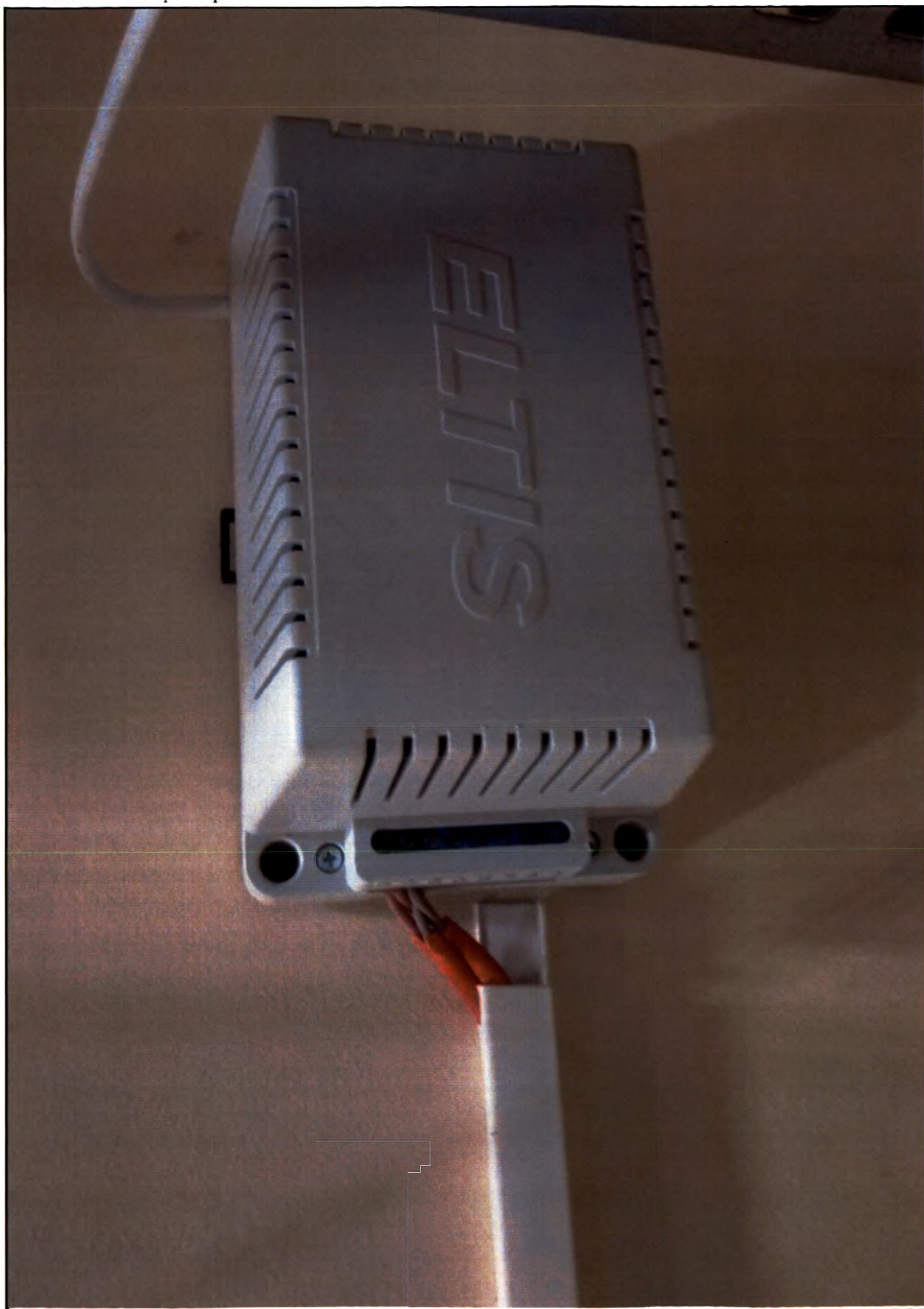
26. Система теленаблюдения за пациентом с переговорным устройством в составе Системный контроллер
