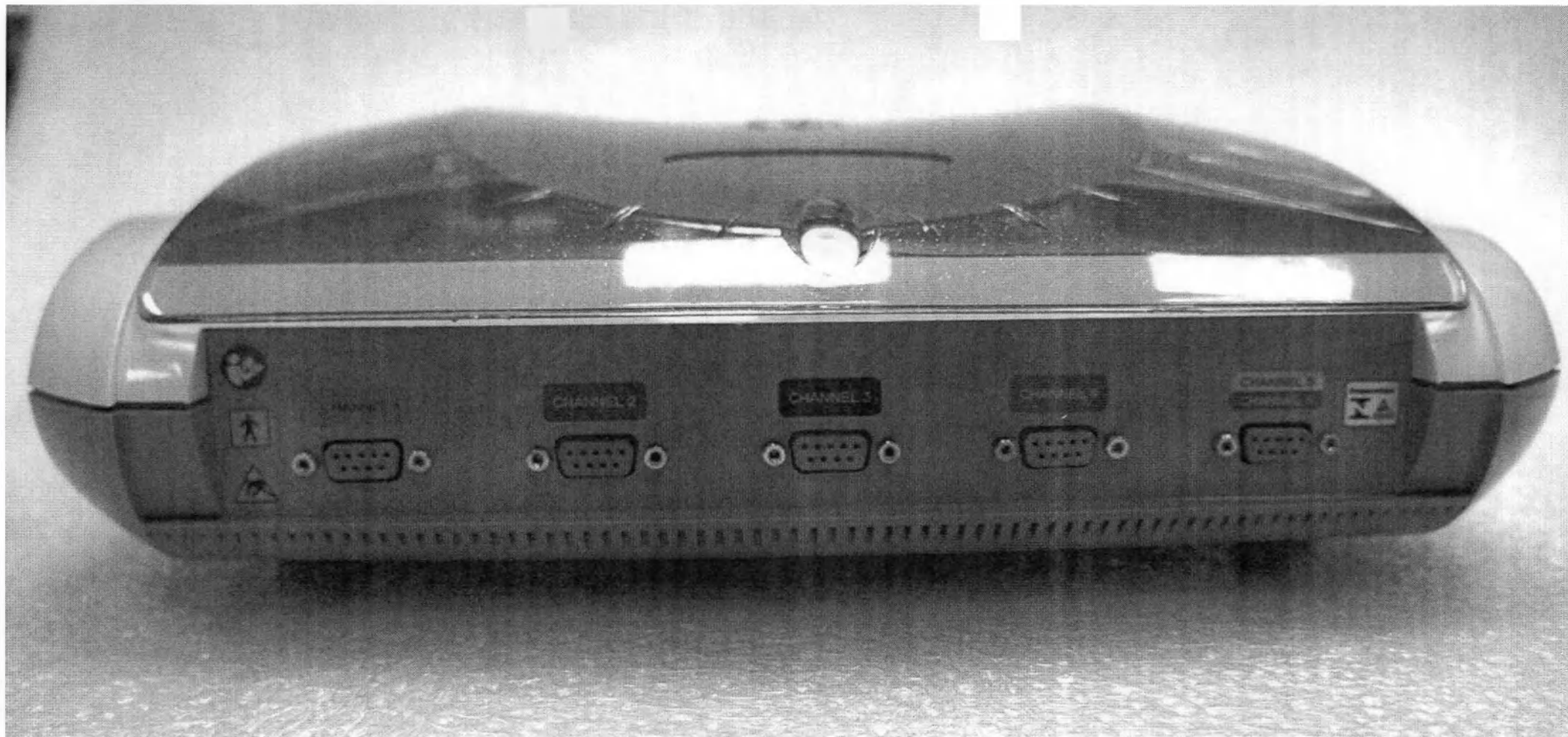
Маркировка выходных каналов.
