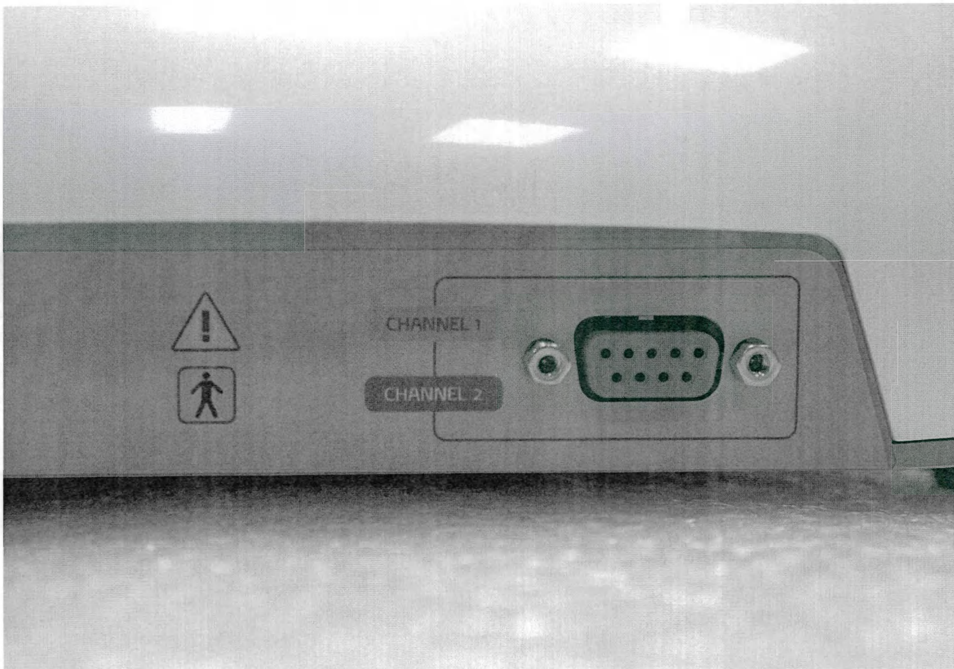
Маркировка выходных каналов.
