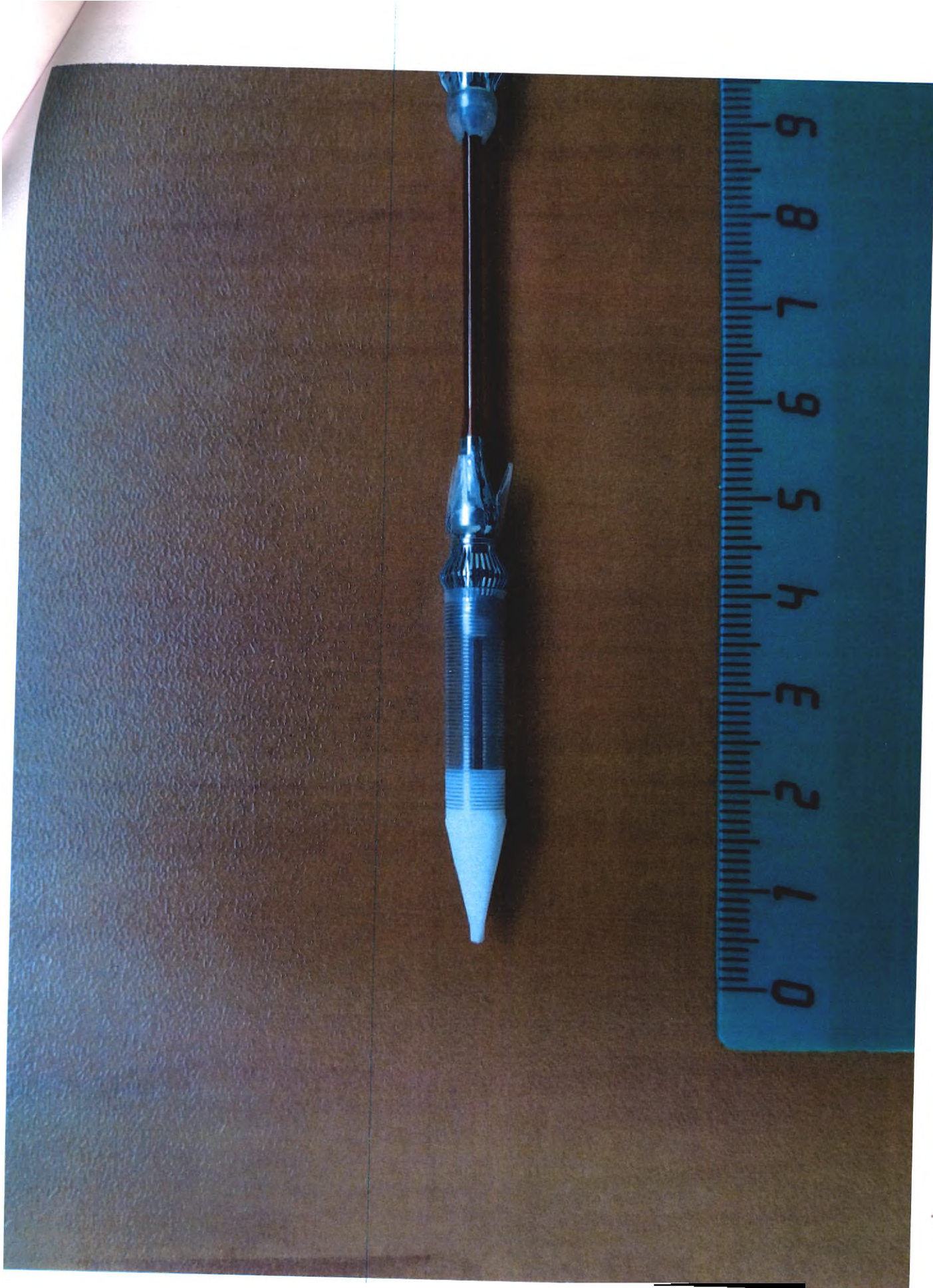
Рентгеноконтрастный атравматический наконечник, капсула, держатель стента с самораскрывающимся каркасом
