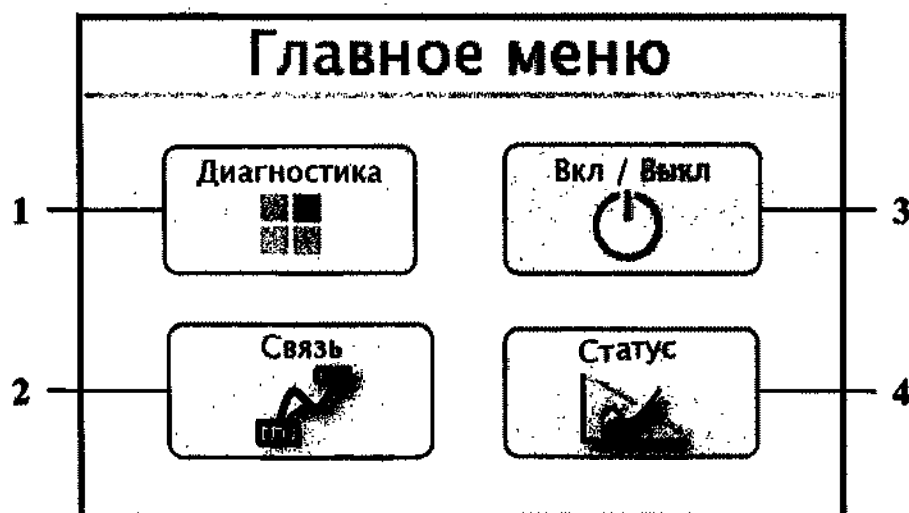
Рисунок 57 – Скрин главного меню ПО МСД: 1 - вызов подраздела, связанного с диагностическими функциями; 2 - вызов подраздела, соответствующего организации связи; 3 - вызов подраздела, управляющего включением и выключением; 4 - вызов подраздела, информирующего о состоянии.
