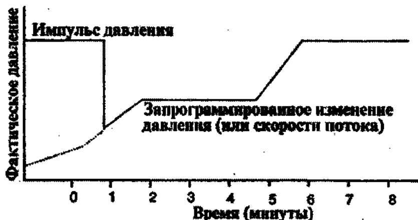
Рисунок 20 – График изменения давления при установлении запрограммированного изменения давления
