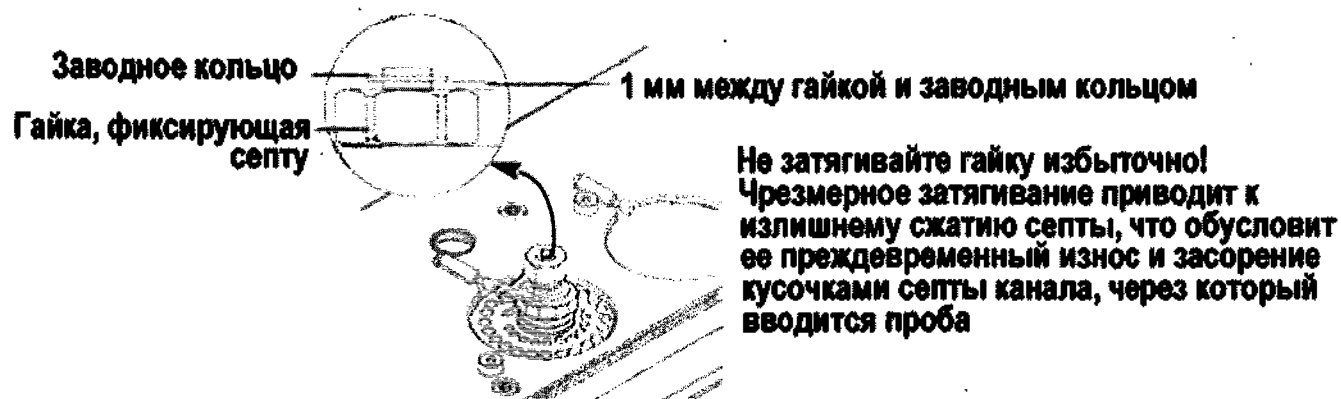
Рисунок 24 – Указания по установке гайки, фиксирующей септу
