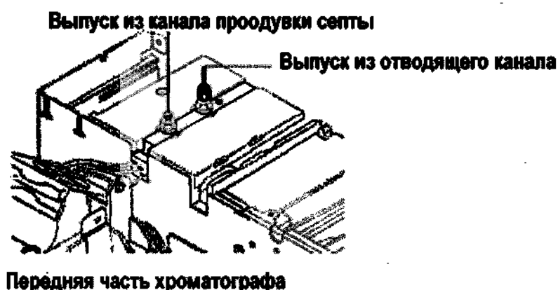
Рисунок 19 – Изображение расположения выпуска из канала продувки септы и выпуска из отводящего канала
