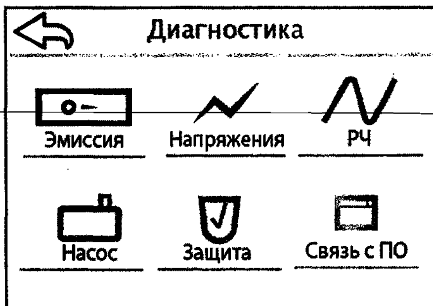
Рисунок 109 – Пример отображения сведений о некорректной работе в окне диагностики ПО МСД
