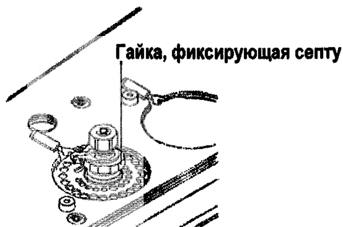
Рисунок 26 – Схематичное изображение расположения гайки, фиксирующей септу
