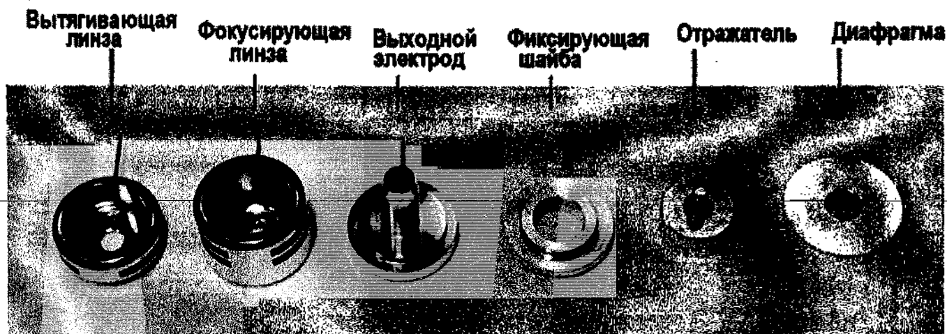
Рисунок 135 – Детали источника ионов, подлежащие чистке
