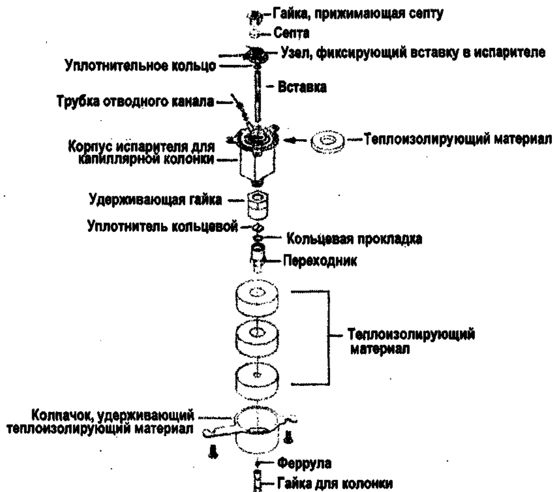
Рисунок 21 – Схема испарителя для капиллярной колонки
