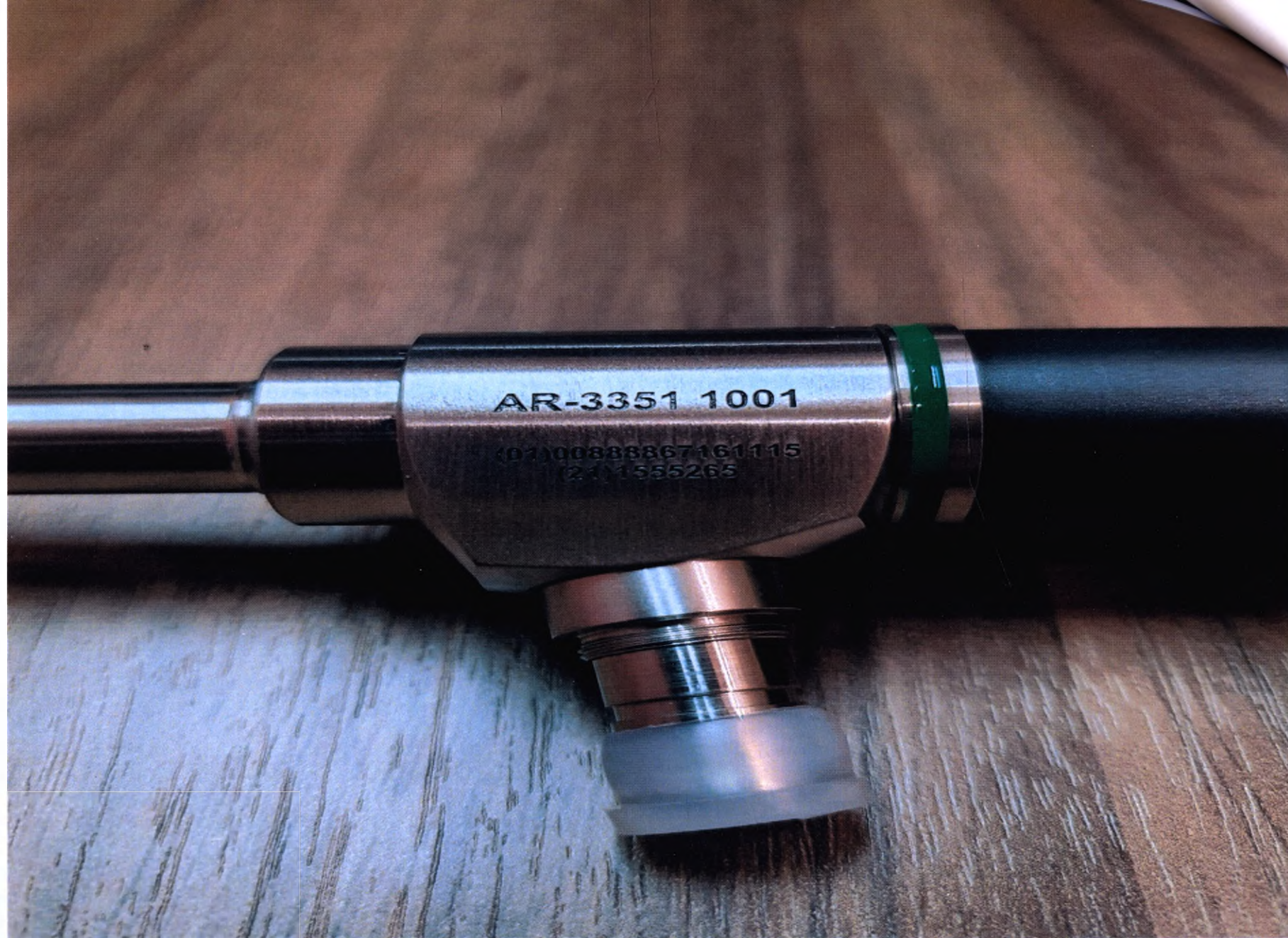
Маркировки на « Лапароскоп 4K, NIR, угол наблюдения 0°, размер: диаметр 10 мм, длина 330 мм.»
