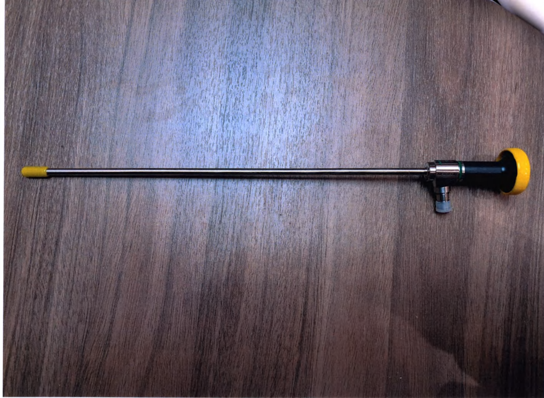
Общий вид 3 – «Лапароскоп 4K Hi-Mag, NIR, угол наблюдения 0°, размер: диаметр 5.5 мм, длина 300 мм.»
