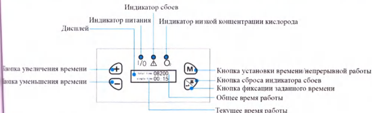
Рисунок 17 Электронный дисплей концентратора кислорода, вариант исполнения МОС-03А, МОС-05А, МОС-08А, МОС-10А).
