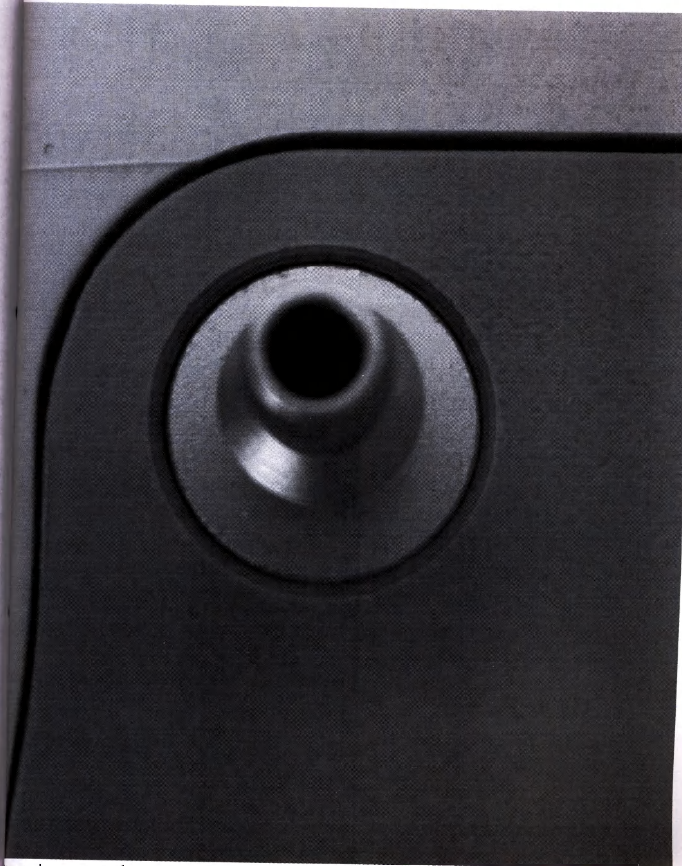
Фотографическое изображение 27. Концентратор кислорода стационарный, модель HO 2 RIZON S5. Отверстие выхода кислорода.
