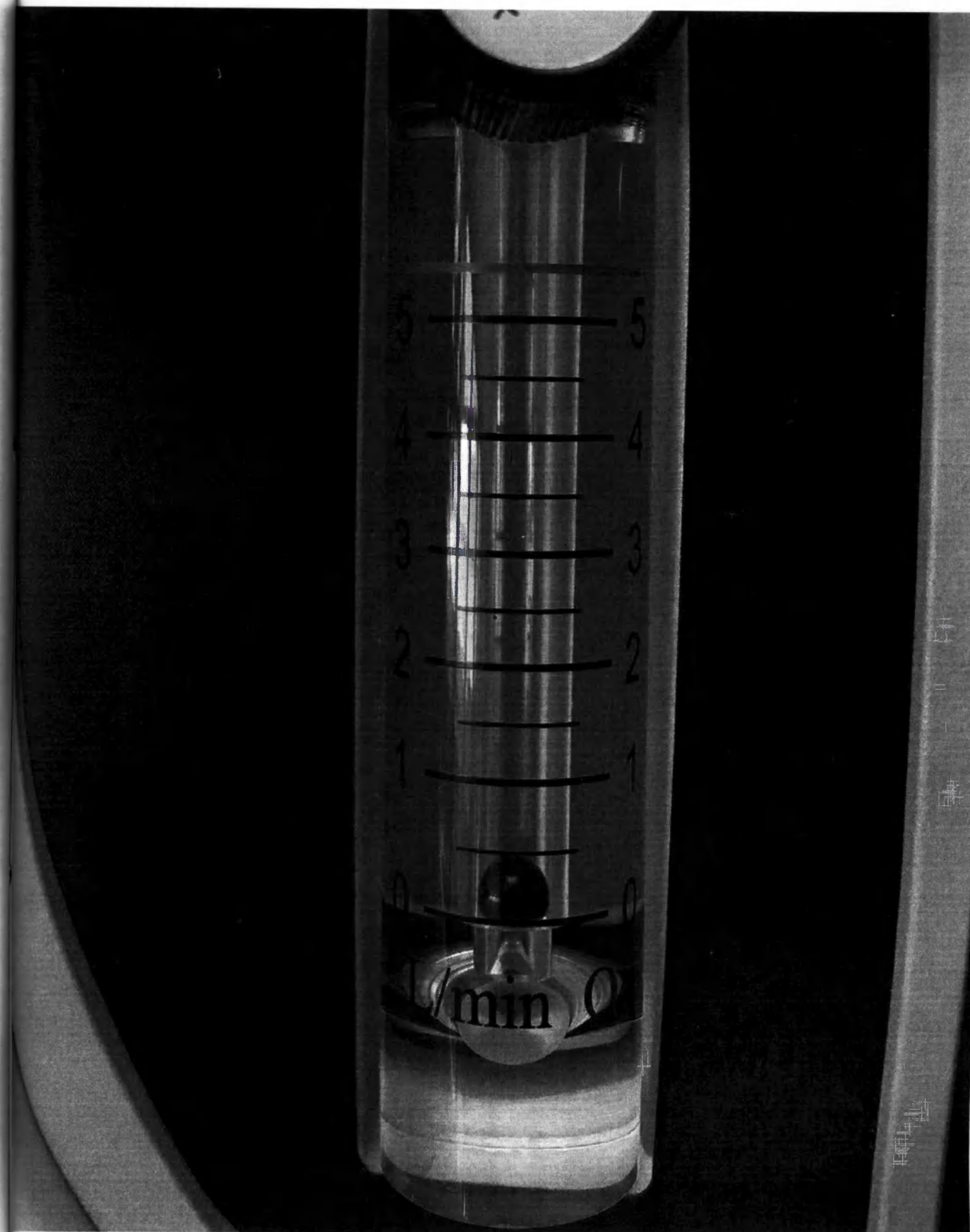
Фотографическое изображение 18. Концентратор кислорода стационарный, модель HO 2 RIZON S5. Расходомер кислорода.
