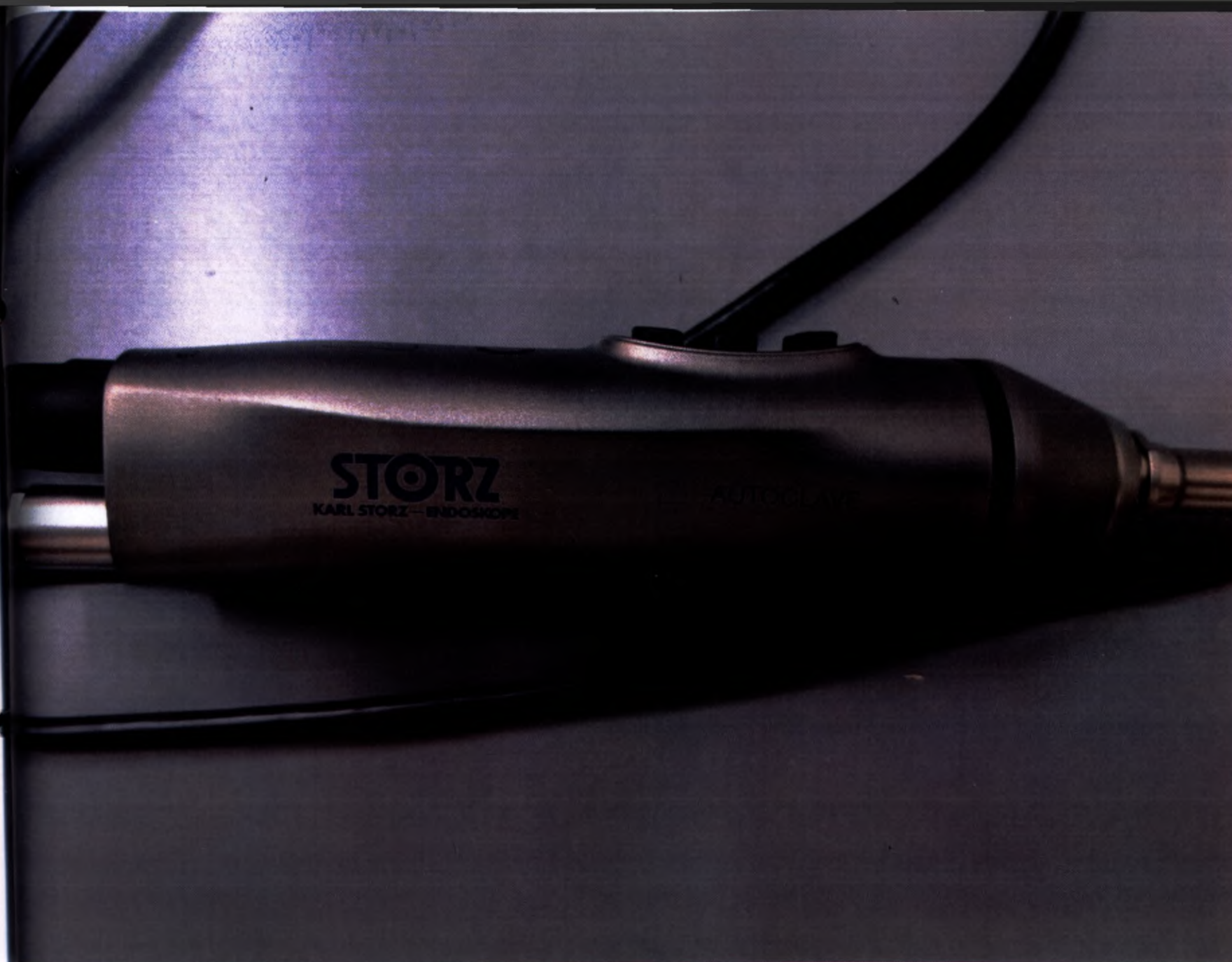
2. Видеоэндоскоп Tipcam 1 Rubina, OPAL1 NIR/ICG, 4K 3D, вариант исполнения: видеоэндоскоп Tipcam 1 Rubina, OPAL1 NIR/ICG, 4K 3D, угол обзора 30°, длина кабеля 3 м, арт.(REF) 26606BCA.
