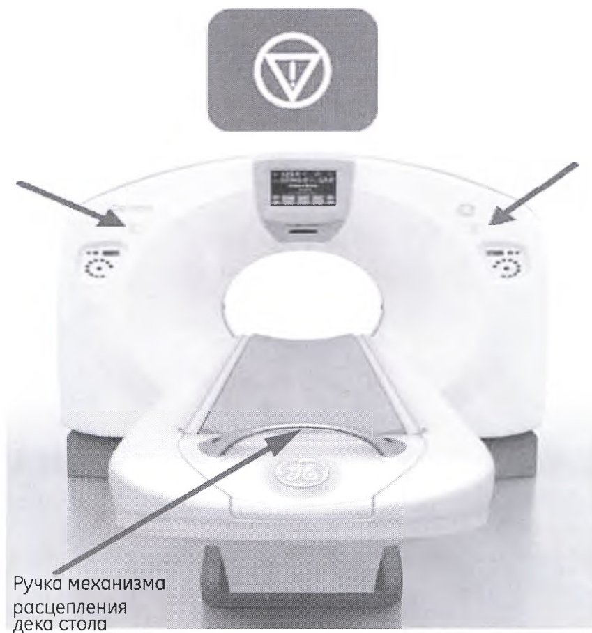
Рис. 2-32 Кнопки аварийной остановки на гентри
