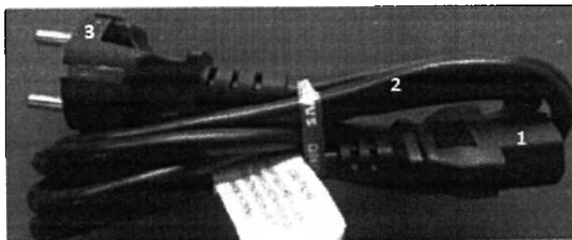
Рисунок 3-125 Кабель питания блока питания детектора
