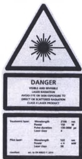
Рисунок 20: Предупреждающий знак о лазере и поясняющая этикетка IEC/EN 60825-1 Эта этикетка содержит информацию об опасностях, максимальных значениях энергии излучения и классификации лазерного источника.
