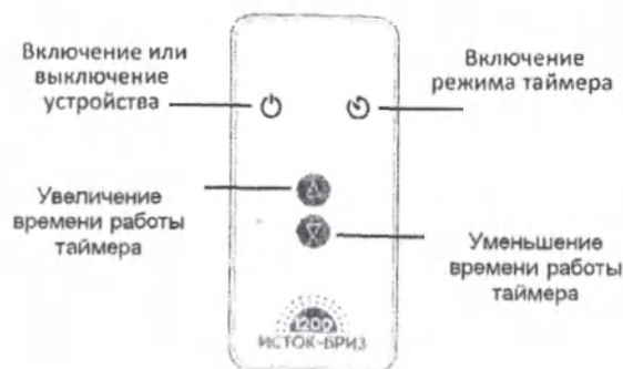
Рисунок 4 – Расположение органов управления дистанционного пульта управления
