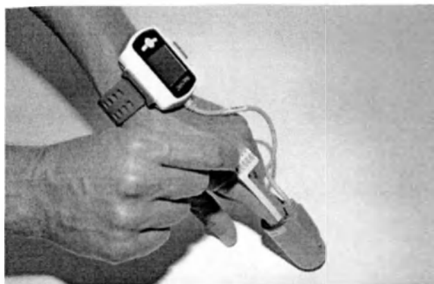
Рис. 26 – Снятие язычка TOP
