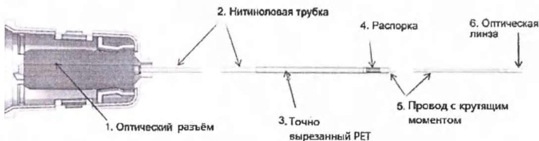
Рисунок 2. Схема внутреннего вращающегося волоконно-оптического сердечника для получения изображения
