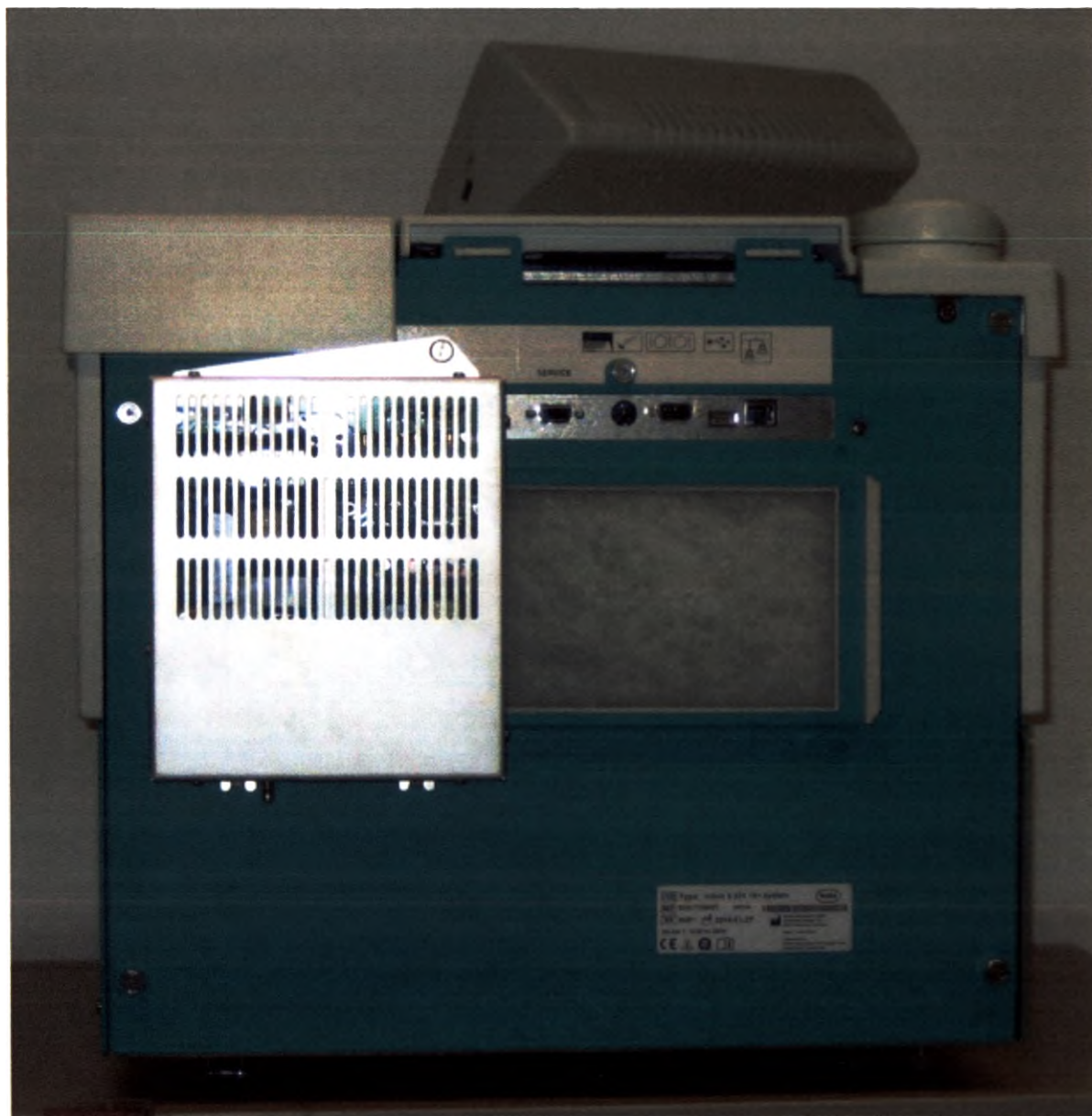
Рисунок 4. Задняя сторона с замененным блоком питания; внесены незначительные изменения, поэтому изменения в данный документ не требуются
