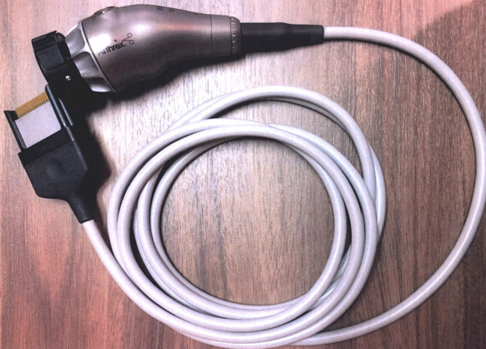
Общий вид – «9. Головка камеры Synergy ID для эндоскопической системы, автоклавируемая, разрешения: 4К»
