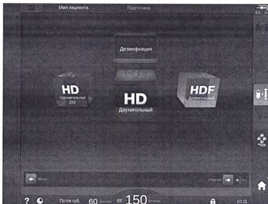
Рис. 8-1 Экран Выбор программы аппарата для HDF
