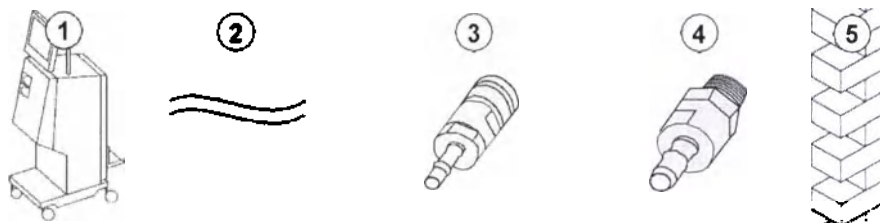
Рис. 4-7 Муфты Aquaboss для централизованной раздачи концентрата
