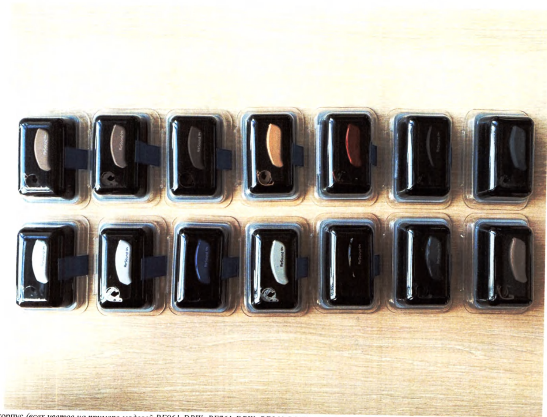
Сменный корпус (всех цветов на примере моделей RE961-DRW; RE761-DRW; RE561-DRW): передняя часть корпуса (TOP HSG ASM); боковая часть корпуса (BOT HSG); дверца батарейного отсека (BAT DOOR ASM);
