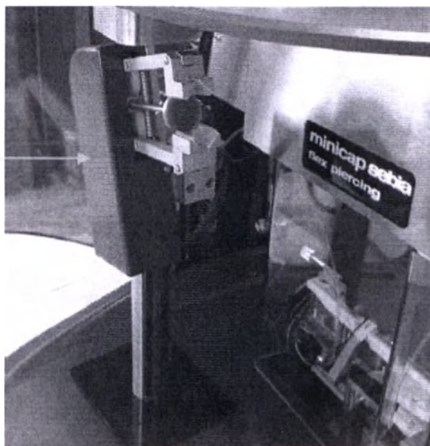
Рисунок 4 - Кронштейн смесителя системы MINICAP FLEX-PIERCING
