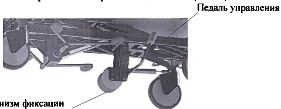
Рисунок 8 - Механизм фиксации направления движения (опция)
